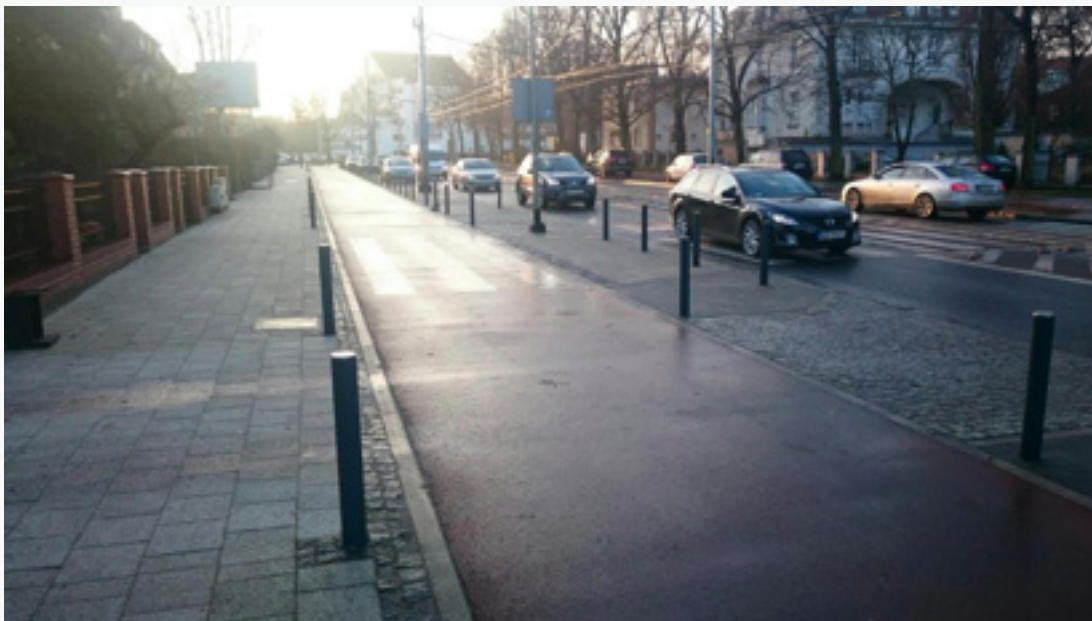
Ilustracja 25: Oddzielenie drogi rowerowej od samochodów i od drogi dla pieszych, w tym także ograniczenie parkowania na drodze rowerowej, opracowanie własne
